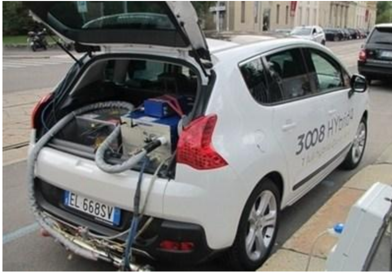
PEMS instalado en un automóvil liviano Euro 6
